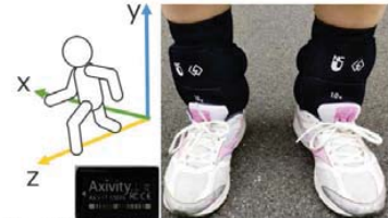
図1 使用した加速度センサの軸およびセンサ・重錘の装着位置
