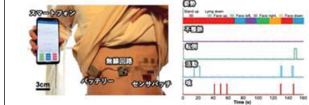
図3. エッジシステムのデモ風景とその解析結果: パルス信号の波上に出ている箇所が、転倒、活動、または咳がありと解析できた
