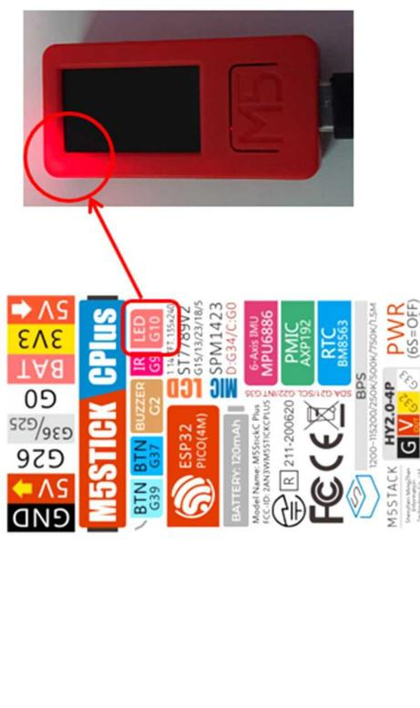
M5StickC-Plusは1個の赤色LEDを内蔵しています。右図は、内蔵しているLEDを点灯した様子を示しています。本体裏側のラベルには、LED G10との表記があります。このマイコンのIOポートG10にLEDが接続されていることを示しています。LEDを点滅させる場合はプログラムでG10のポートにHigh(1) / Low(0)を交互に出力することができます。
