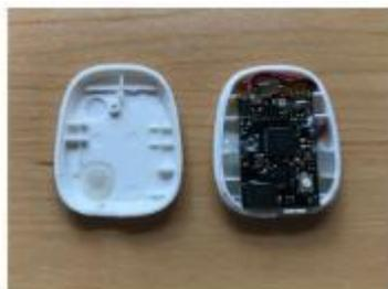
図 9: 実験で使用した IMU センサ
