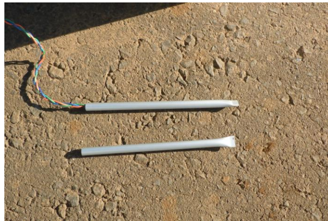
図 6.8 温度センサーの加工(アルミパイプの先端をカシメて封入しました)
