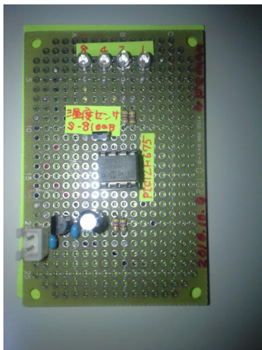
簡易温度計の基板（表・裏）
