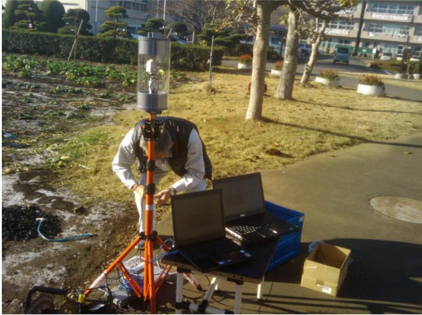
図表 40 第2日目 フィールドサーバの設置作業
