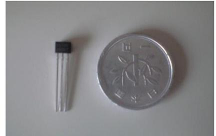
上記は、温度に対応する電圧を出力するセンサーですが、電圧値をコンピュータ処理するためには温度換算しなければいけません。A/D変換過程・温度換算過程で誤差が生じます。これを解消するために、直接温度数値を出力してくれるデジタル温度センサーもあります。LM75BDがそれで、価格も安く（50円くらい）I2Cインタフェースをもつマイコンならば簡単に接続ができて、温度を直読する事ができます。
