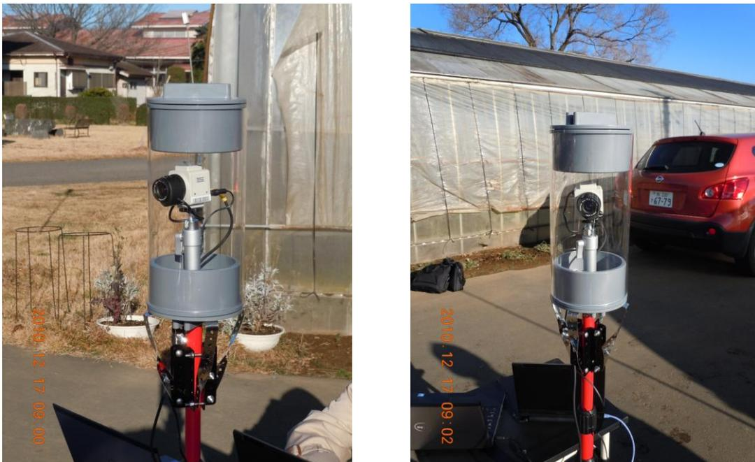
図 3.3 開発した、フィールドサーバ用カメラ
