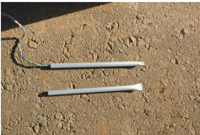
図 3.8 温度センサーの加工(アルミパイプの先端をカシメて封入しました)
