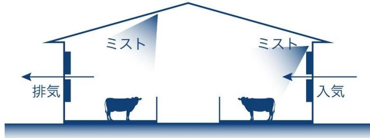
温度調整の仕組み
