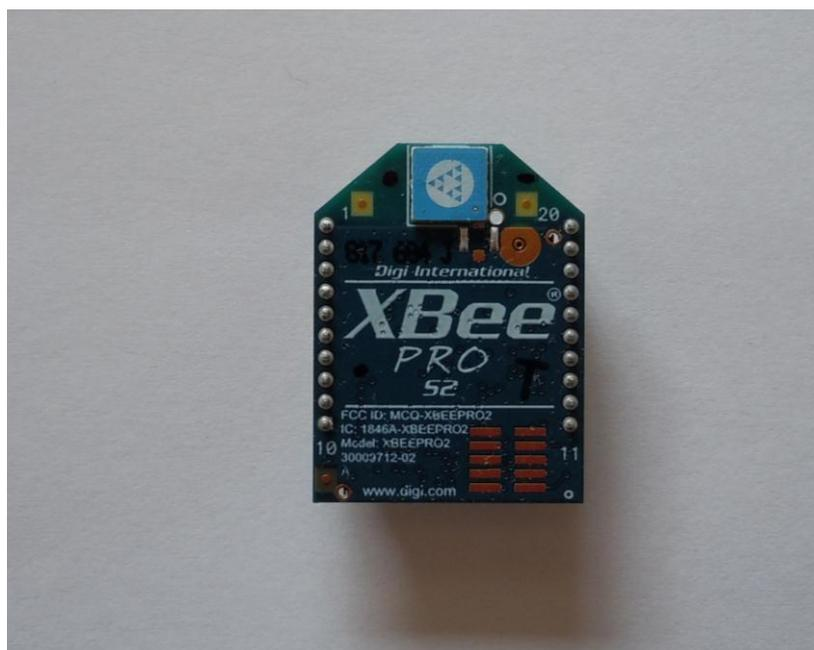
図表 94 XBee 無線モジュール
